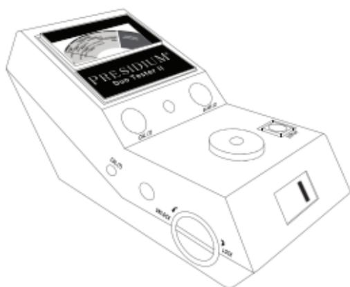
Drücken Sie die Sondenspitze erneut gegen die „CAL“-Scheibe und stellen Sie sicher, dass die Sondenspitze ganz heruntergedrückt und in das Gehäuse des Sondenstifts zurückgezogen ist. Bitte achten Sie darauf, dass Ihre Finger den metallischen Chrombereich des Sondenstifts berühren. Die Nadelanzeige wird automatisch auf den roten „CAL“-Streifen kalibriert. Nach Abschluss der „CAL“-Kalibrierung piept der Summer zwei Mal.
