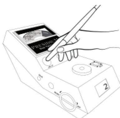
Die Reflektionsanzeige zeigt dann eine blinkende „2“. Drücken Sie den Sondenstift erneut gegen die „Glas“-Scheibe und befolgen Sie die obigen Schritte zum Umgang mit dem Sondenstift. Die Nadelanzeige wird automatisch auf den roten „Glas“-Streifen kalibriert. Nach Abschluss der „Glas“-Kalibrierung piept der Summer zwei Mal und damit ist der Kalibriervorgang beendet.
